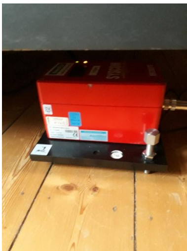
Figuur 5 – meetopstelling hinder slaapkamer
